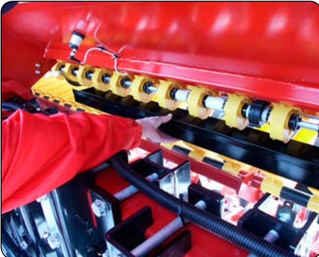
Kuva 3.5 Kiertokoeaukalon asettaminen paikoilleen.
